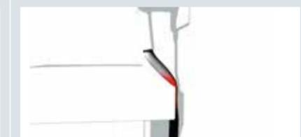
Werden Stecker und Leitungen beispielsweise durch unachtsam verschobene Möbel abgeknickt oder eingeklemmt, können ebenso Fehlerlichtbögen auftreten.
