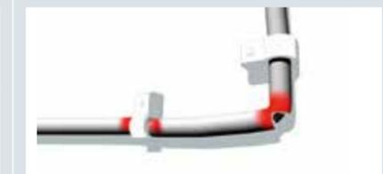
Gefahr besteht auch bei Kabelbrüchen, wie sie durch zu enge Biegeradien bei der Verlegung des Kabels entstehen. Ebenso können zu heftig eingeschlagene Befestigungsklammern die Isolierung beschädigen.
