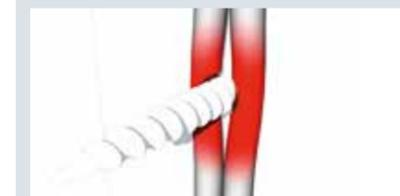
Beschädigte Leitungsisolierungen, z. B. durch Nägel oder Schrauben, können zu Isolationsfehlern führen.
